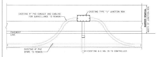
EXISTING SURVEILLANCE JUNCTION BOX ELEVATION REFERENCE
