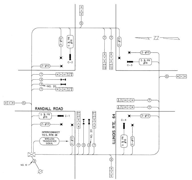
STAGE 1 & 2 TEMPORARY TRAFFIC SIGNAL CABLE PLAN
