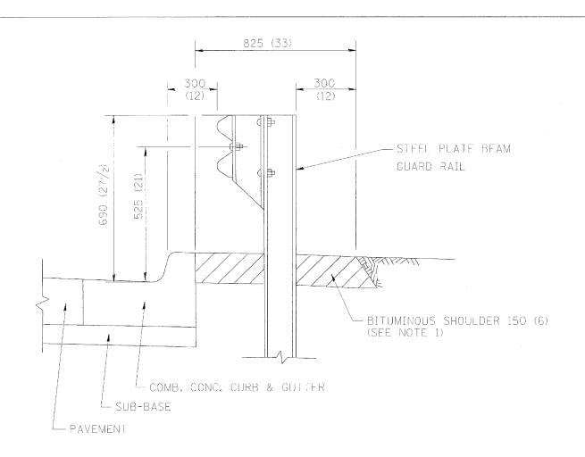
NOTES: 1. THE BITUMENOUS SHOULDER SHALL EXTEND UNDER THE TRAFFIC BARRIER TERMINAL
