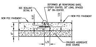
TYPE E - HINGED-KEYED **CONSTRUCTION JOINT**
