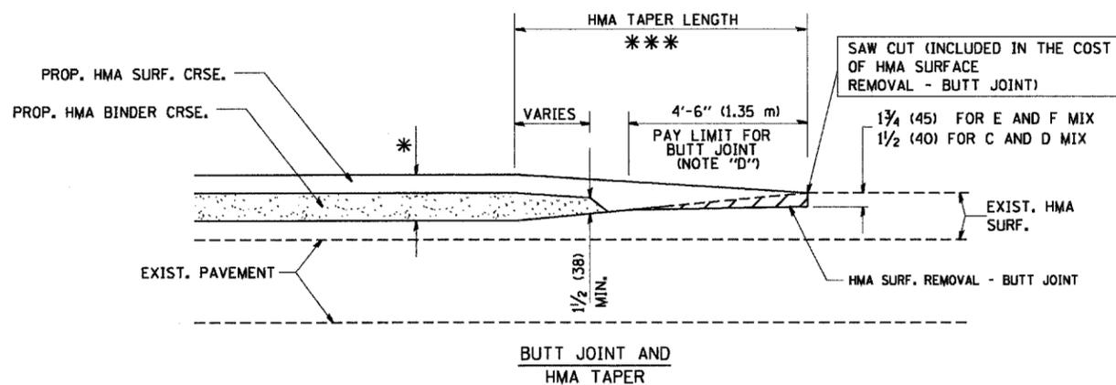
**TYPICAL BUTT JOINT AND HMA TAPER
