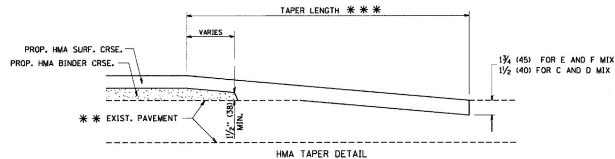
**TYPICAL BUTT JOINT AND HMA TAPER
