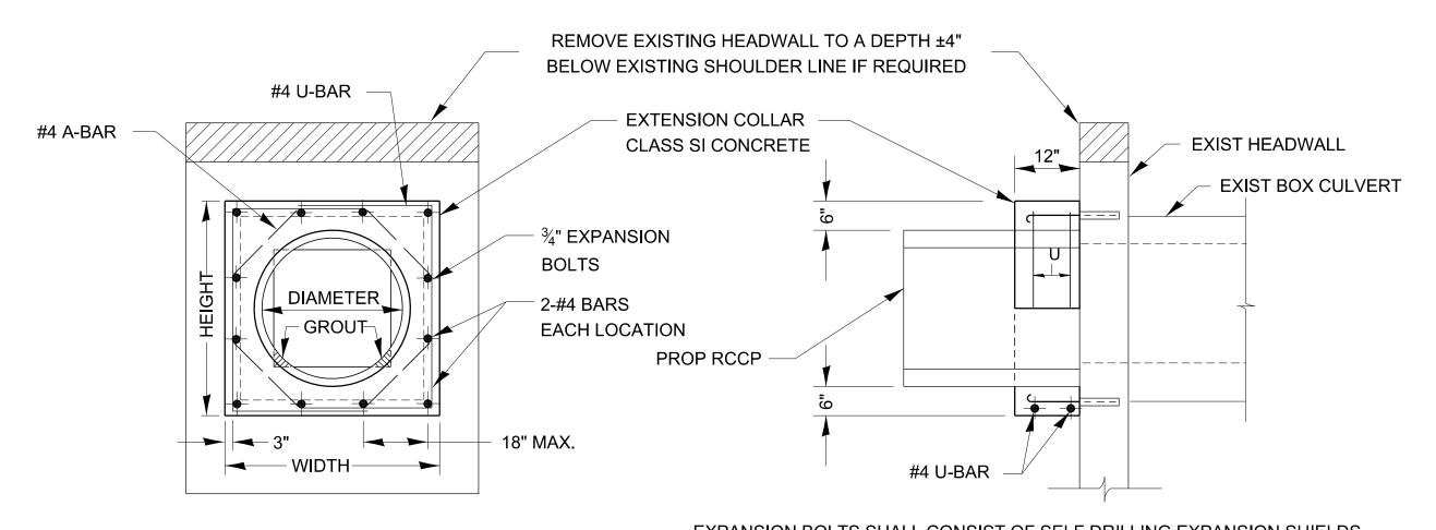
EXPANSION BOLTS SHALL CONSIST OF SELF DRILLING EXPANSION SHIELDS
