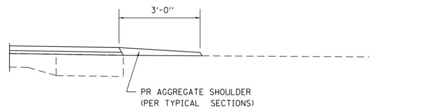
**SECTION A-A FOR EX EARTH/ AGGREGATE FE**
