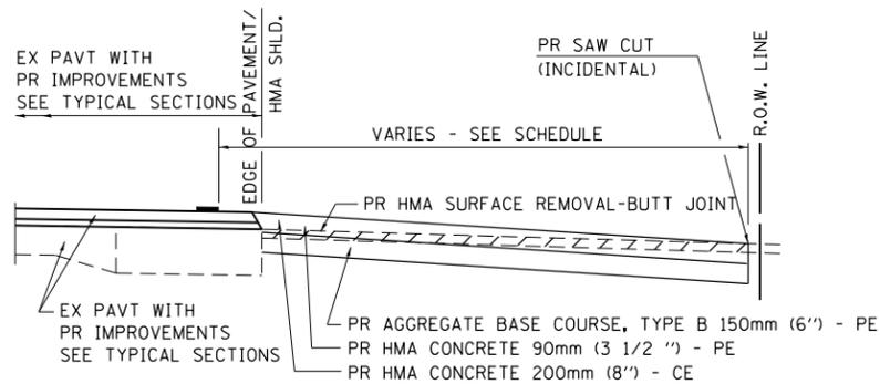
**SECTION A-A FOR EX HMA PE & CE**
