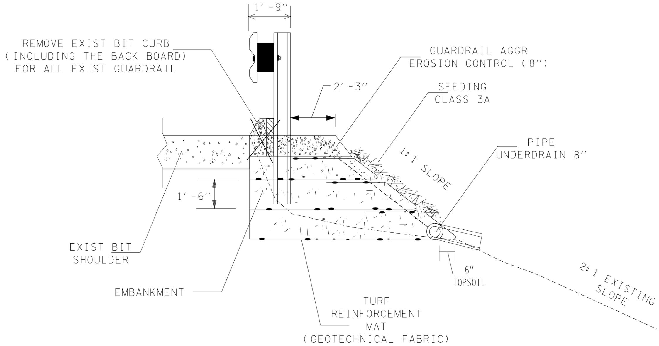
EARTH REINFORCEMENT DETAIL & TYPICAL SECTION
