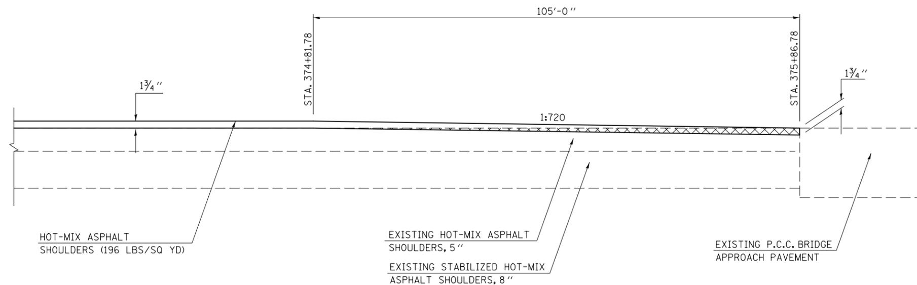
HMA SURFACE REMOVAL - BUTT JOINT
