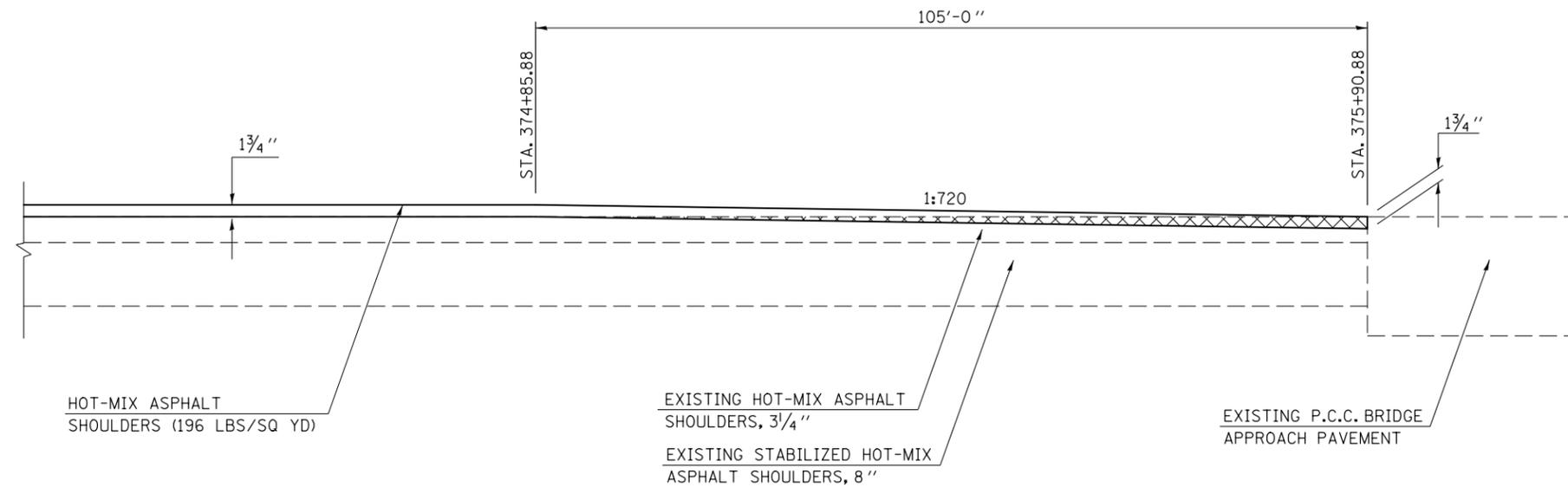
HMA SURFACE REMOVAL - BUTT JOINT
