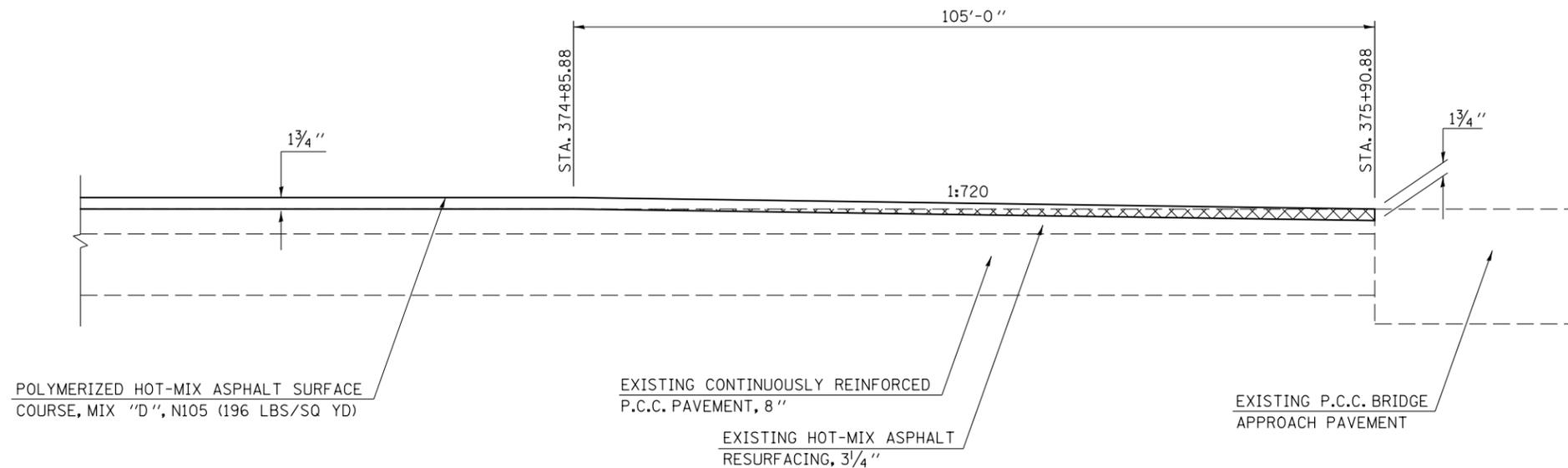
HMA SURFACE REMOVAL - BUTT JOINT
