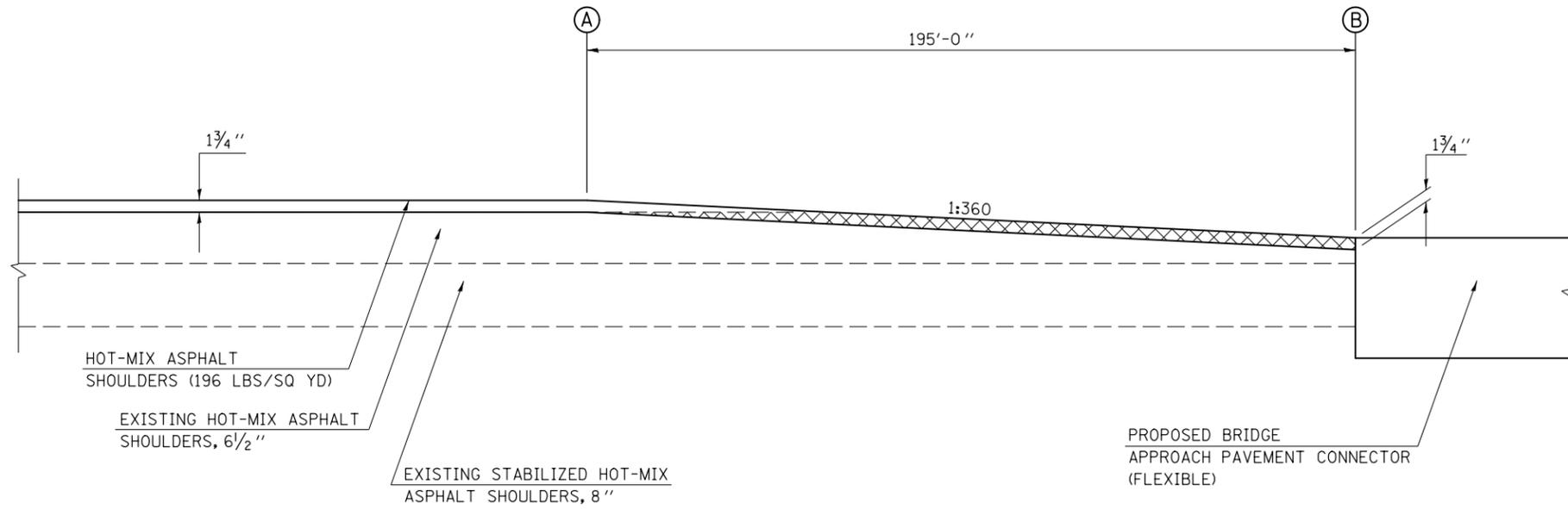
HMA SURFACE REMOVAL - BUTT JOINT
