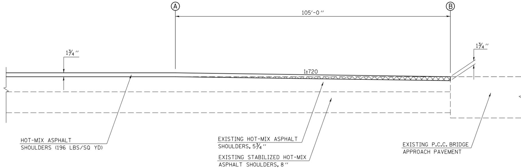
HMA SURFACE REMOVAL - BUTT JOINT
