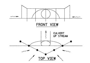
UPSTREAM PIPE CULVERT EROSION CONTROL
