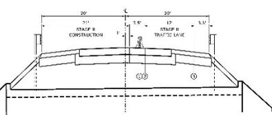
STAGE II CONSTRUCTION TYPICAL SECTION
