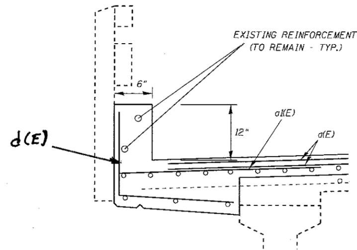
**PARAPET CROSS SECTION AT JOINT**
