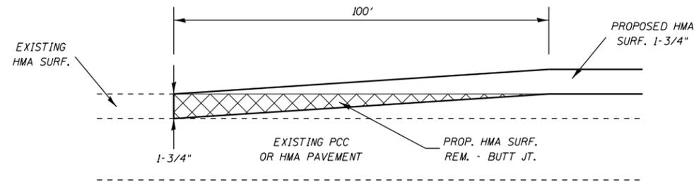
BUTT JOINT ELEVATION
