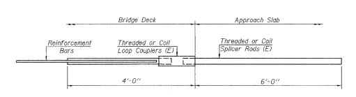
ROLLED THREAD DOWEL BAR
