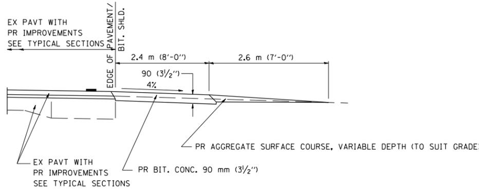
**SECTION A-A FOR EX EARTH/AGGREGATE PE**
