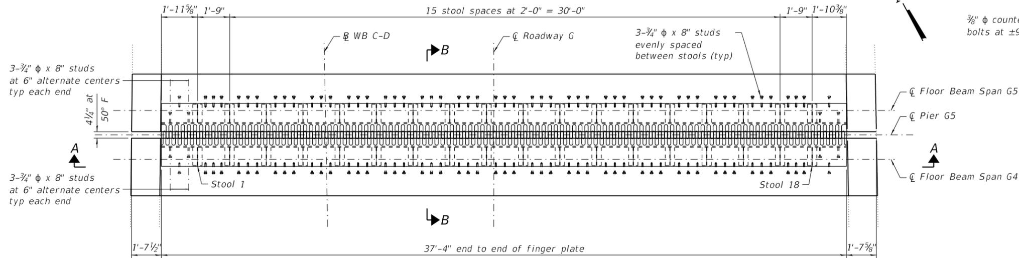
**PLAN OF FINGER PLATE EXPANSION JOINT AT PIER G5**
