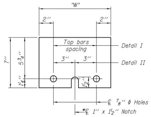
**STEEL RETAINER  $\bar{P}$  1" x 7" x "W"**
