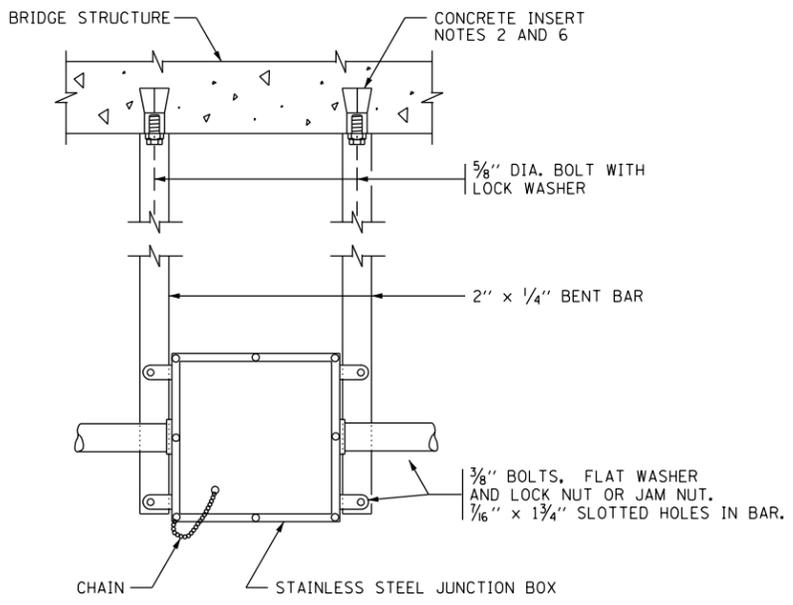
**JUNCTION BOX SUSPENDED FROM STRUCTURE DETAILS**
