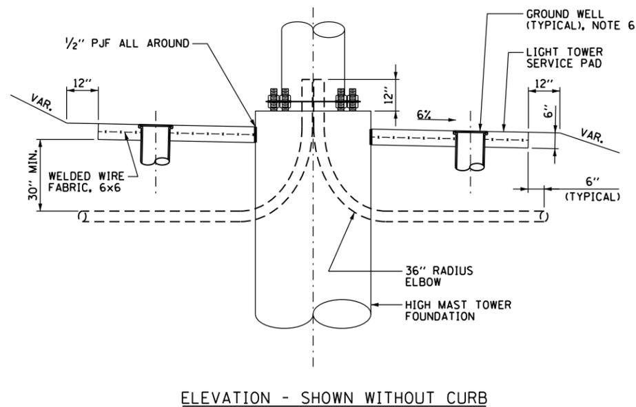
GROUND MOUNTED HIGH MAST TOWER SERVICE PAD,
