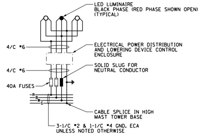
TYPICAL HIGH MAST LIGHT TOWER WIRING DIAGRAM
