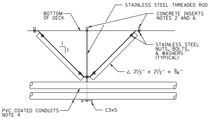
**CENTERING DEVICE DETAIL - SIDE VIEW**
