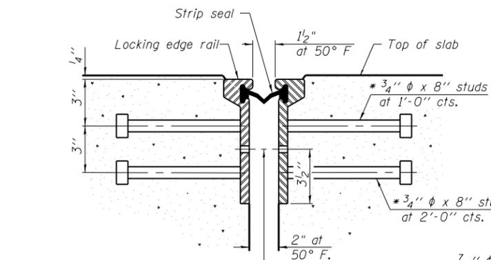
**SECTION THRU ROLLED RAIL JOINT**
