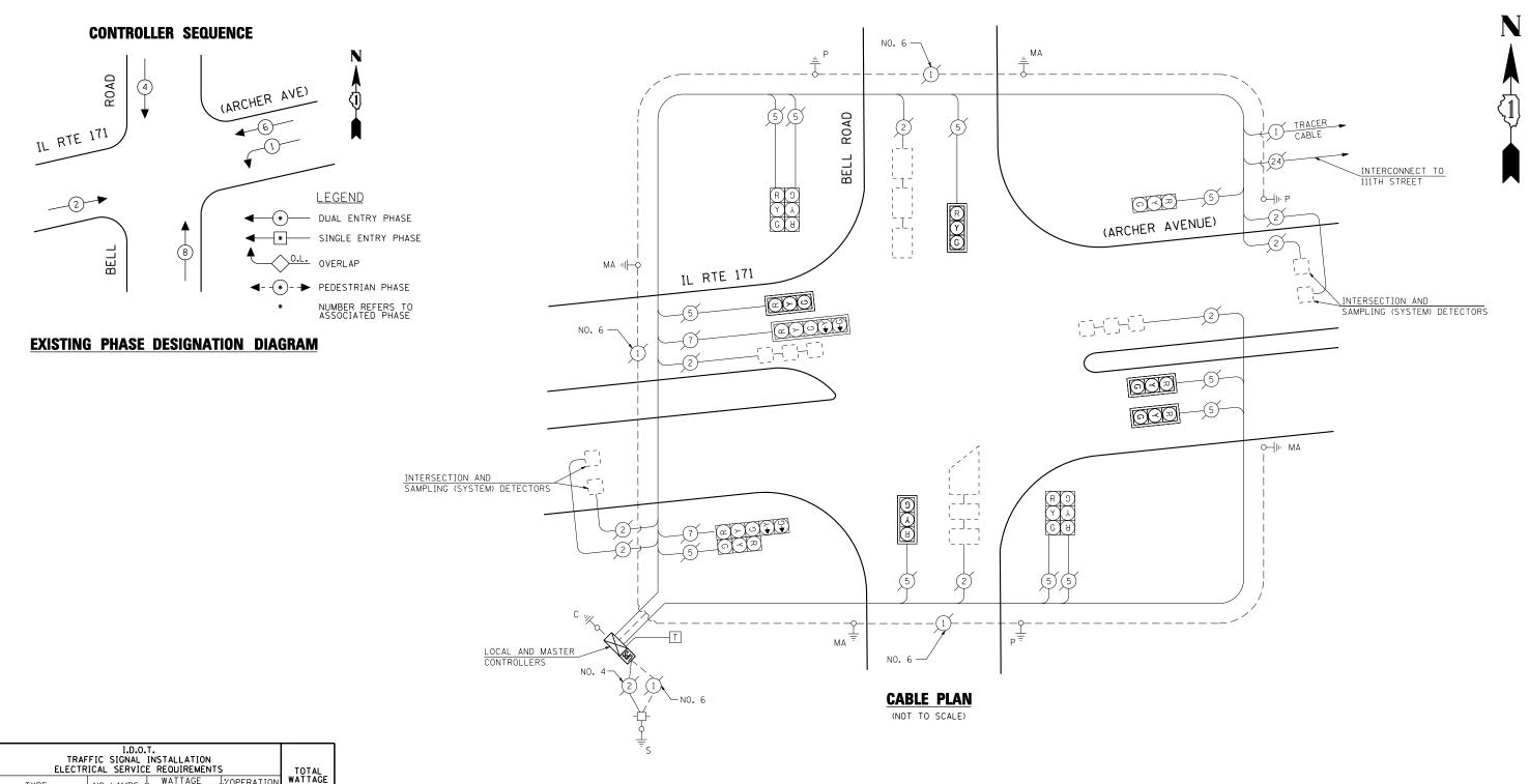
TYPE NO LAMPS WATTAGE %OPERATION INCAND. LED SIGNAL (RED) 13 135 17 0.50 110.50 (YELLOW) 13 135 25 0.25 81.25 (GREEN) 13 135 15 0.25 48.75 ARROW 4 135 12 0.10 4.80 PED. SIGNAL 90 25 1.00 CONTROLLER 1 100 100 1.00 100.00 ILLUM. SIGN 84 0.05
