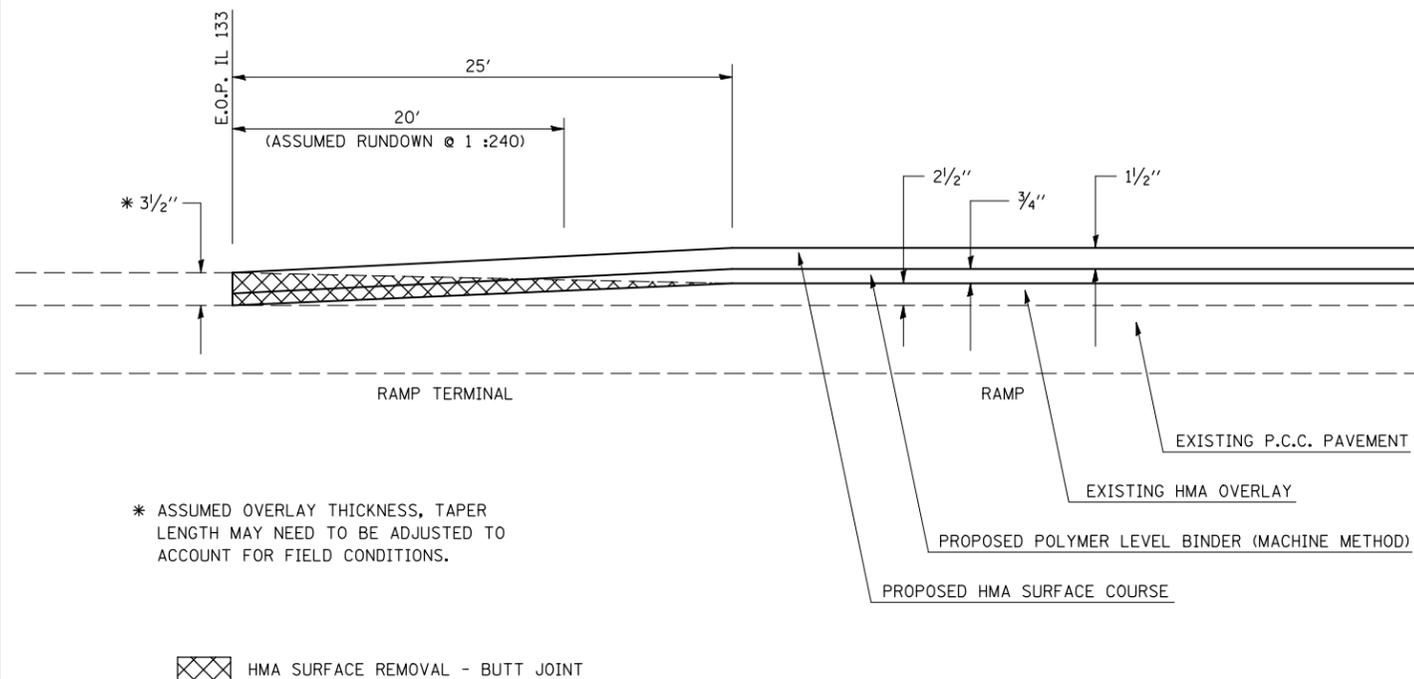
**DETAIL OF BUTT JOINTS AT RAMPS A, B, C & D**
