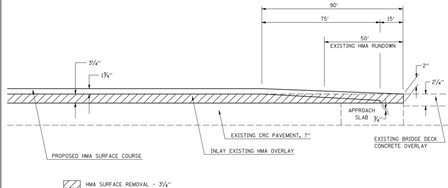
**DETAIL OF BUTT JOINT - PASSING LANE**
