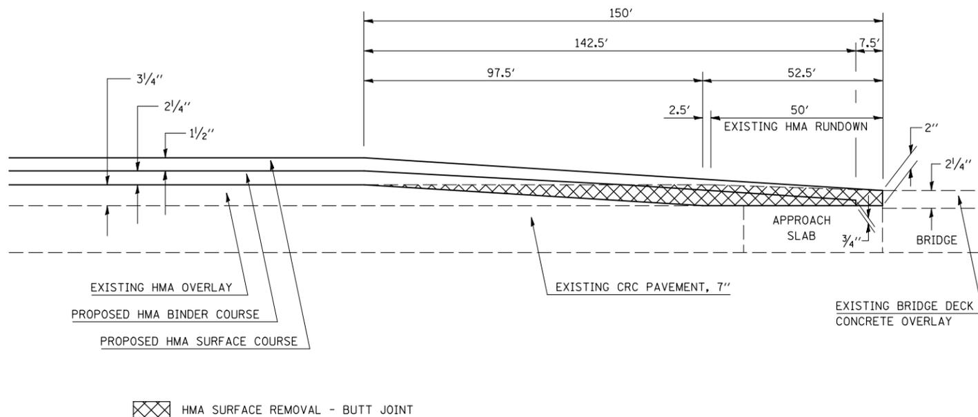
**DETAIL OF BUTT JOINT - PASSING LANE**
