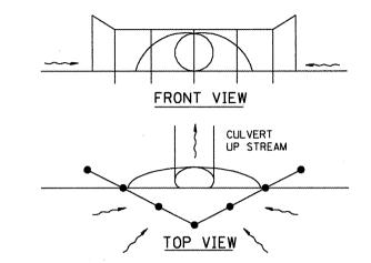
UPSTREAM PIPE CULVERT EROSION CONTROL
