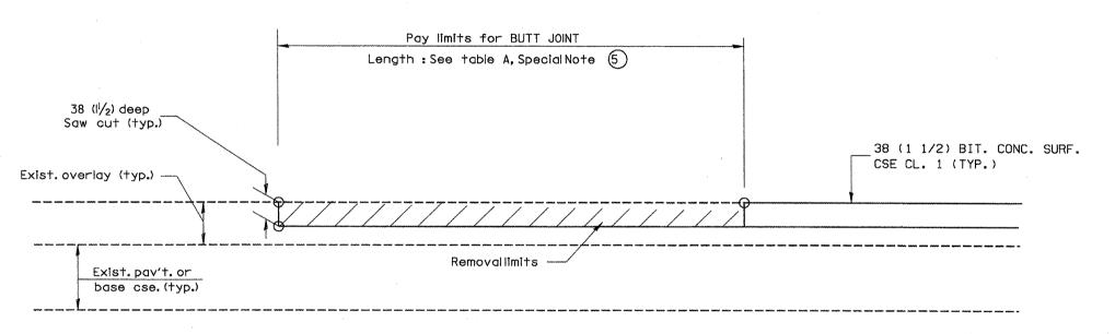
CASE 5: WITH BITUMINOUS SURFACE REMOVAL (COLD MILLING) TIE-IN TO EXISTING BITUMINOUS TAPER
