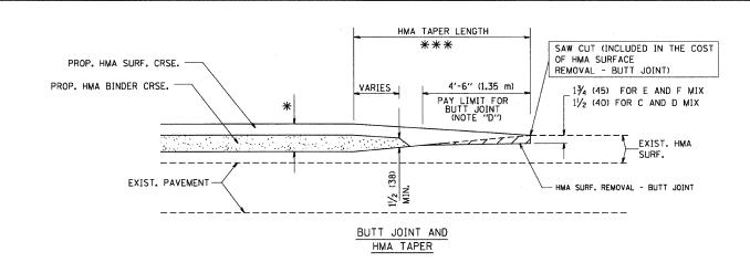
TYPICAL BUTT JOINT AND HMA TAPER
