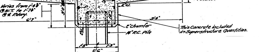
*SECTION THRU PIER PILE CAP*
