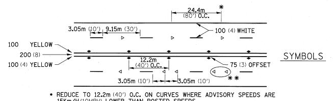
\* REDUCE TO 12.2m (40') O.C. ON CURVES WHERE ADVISORY SPEEDS ARE 15Km/H(10MPH) LOWER THAN POSTED SPEEDS.
