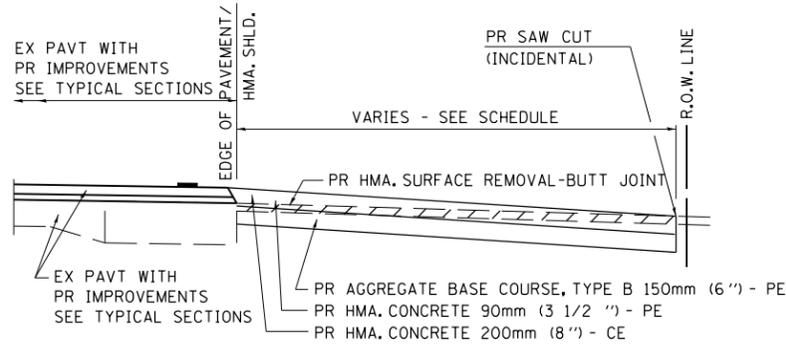
**SECTION A-A FOR EX HMA PE & CE**
