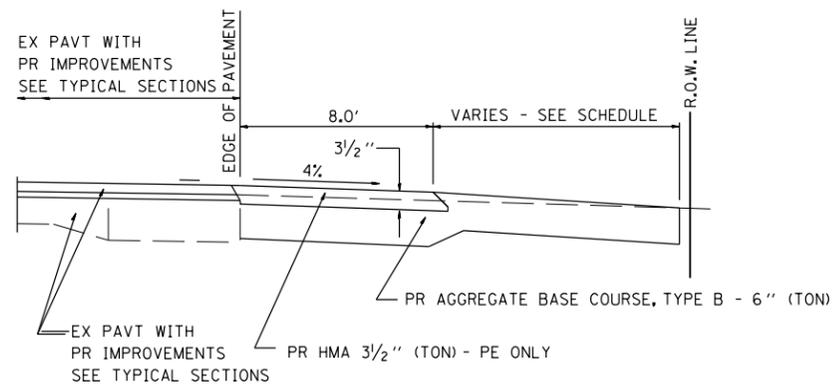
SECTION A-A FOR EX EARTH/AGGREGATE FE & PE
