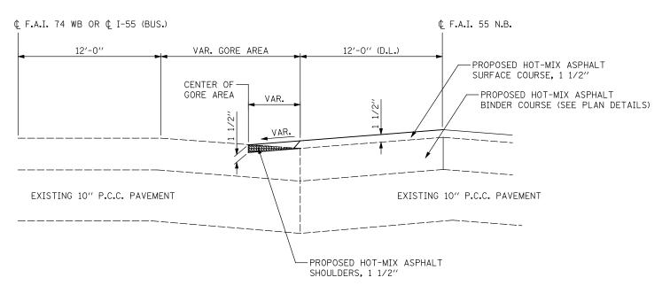
HOT-MIX ASPHALT SURFACE REMOVAL - BUTT JOINT
