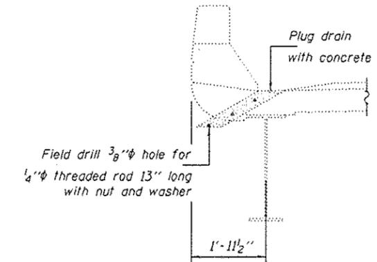
**SECTION THRU DRAIN TO BE PLUGGED**
