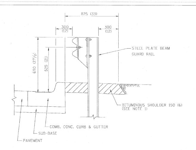
NOTES: 1. THE BITUMINOUS SHOULDER SHALL FXTEND UNDER THE TRAFFIC BARRIER TERMINAL
