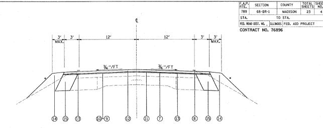
PROPOSED TYPICAL SECTION STA. 107+59.00 TO STA. 108+59.00 STA. 108+89.00 TO STA. 109+89.00
