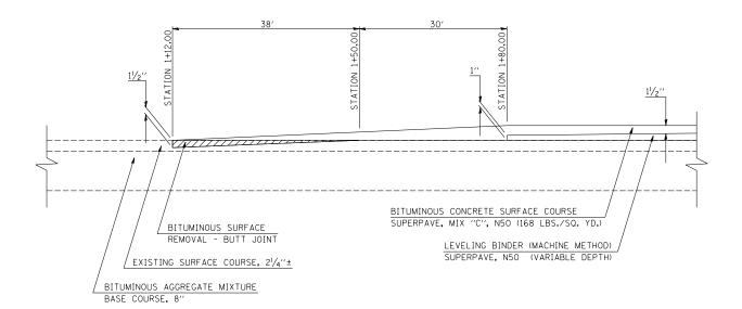
BITUMINOUS SURFACE REMOVAL - BUTT JOINT
