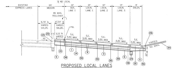
STA. 4529+00 TO STA. 4531+18.51 - SUPERELEVATION = 5.9% (SUPERELEVATION TRANSITION SECTION FROM STA. 4531+18.51 TO STA. 4536+66.66 IS SIMILAR)
