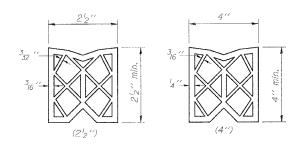
PREFORMED JOINT SEAL
