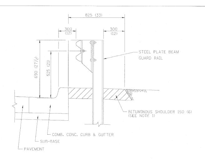
NOTES: 1. THE BITUMINOUS SHOULDER SHALL EXTEND UNDER THE TRAFFIC BARRIER TERMINAL
