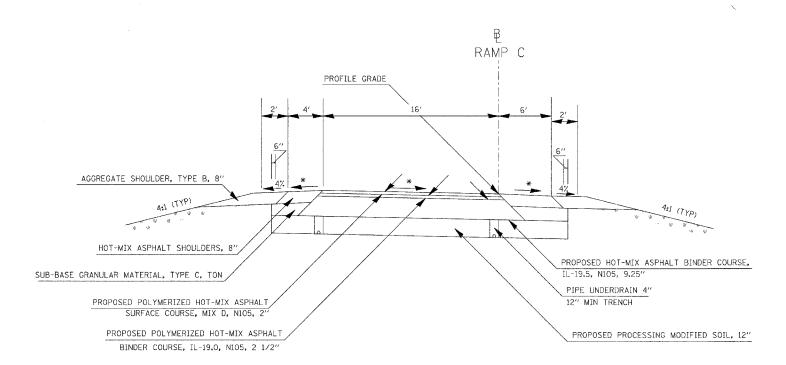
ATTAIN SUPERELEVATION STA 502+25.12 TO STA 504+45.12
