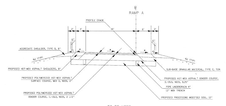
ATTAIN SUPERELEVATION STA 302+28,34 TO STA 304+48.34
