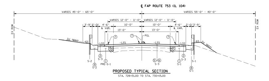
SEE PLAN VIEW FOR GUARDRAIL LOCATIONS AND SHOULDER TAPERS.
