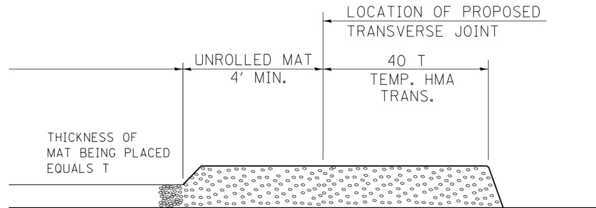
PLACE HOT-MIX ASPHALT MAT, LENGTH 40 TIMES THE THICKNESS OF THE MAT BEING PLACED PAST THE PROPOSED TRANSVERSE JOINT LOCATION USING NORMAL OPERATING PROCEDURES.
