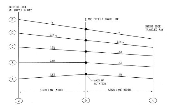
TYPICAL SUPERELEVATION TRANSITION DETAILS
