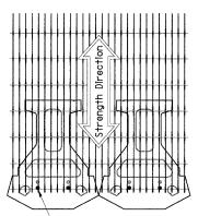
GEOGRID IS TO BE PLACED ON LEVEL BACKFILL AND EXTENDED OVER THE FIBERGLASS PINS. PLACE NEXT UNIT. PULL GRID TAUGHT AND BACKFILL. STAKE
