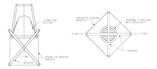
\*INSTALL PER IDOT STANDARD 280001-04 \*\*PAID FOR AS PERIMETER EROSION BARRIER
