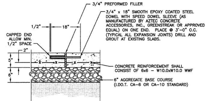
SIDEWALK AND EXPANSION JOINT DETAIL
