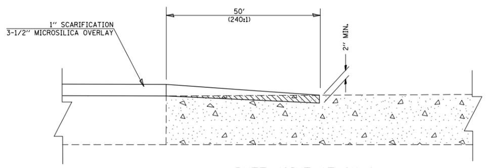
BUTT JOINT AT CH 4
