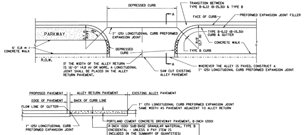
IF THE WIDTH OF THE ALLEY RETURN IS 16'-0" (4.8 m) OR MORE, A LONGITUDINAL JOINT SHALL BE PLACED IN THE ALLEY RETURN PAVEMENT.
