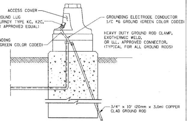
**MAST ARM POLE / POST-GROUNDING DETAIL**
